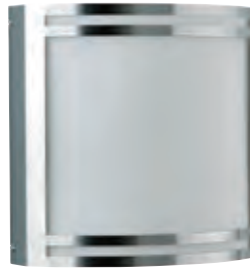
3216411. Edelstahl, LED austauschbar, dimmbar, inkl. Überspannungsschutz, 10 W LED, 3000 K, 900 lm, H 255, B 255, A 130 € 238,60
